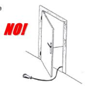
Occorre evitare di avere fasci di cavi, prese multiple e comunque connessioni elettriche sul pavimento. Possono essere causa d'inciampo o, sopratutto se deteriorati, costituire pericolo per chi effettua le operazioni di pulizia del pavimento con acqua o panni bagnati. Devono, quindi, venire adottati sistemi per sostenere e proteggere i cavi di alimentazione e di segnale
