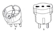
Gli adattatori multipli consentiti dalle norme sono quelli con due sole prese laterali. L'altro tipo, con una terza presa parallela agli spinotti, viene considerato pericoloso perché consente l'inserimento a catena di più prese multiple. Il pericolo deriva dalla possibilità di superare la corrente massima sopportabile dalla presa e dalla possibilità di cedimento meccanico della presa e degli adattatori a causa del peso eccessivo sugli alveoli.
